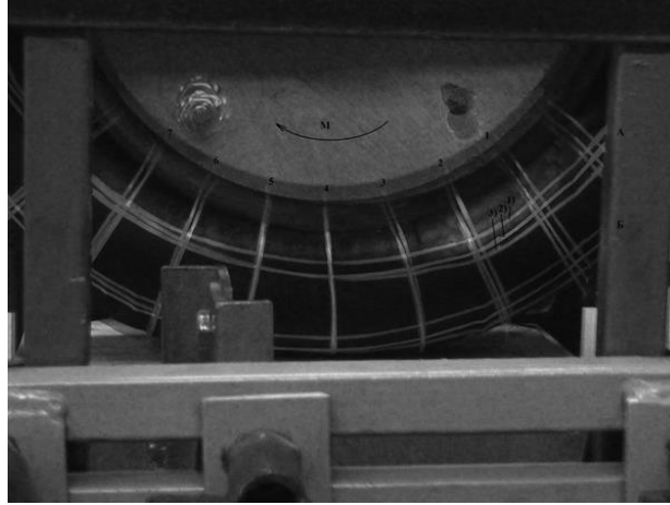
Рис. 2. Совмещение изображений шины с одинаковой вертикальной нагрузкой при разных моментах
