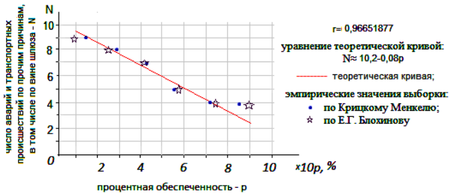
Рис. 3. Кривая обеспеченности аварий и транспортных происшествий в судоходных шлюзах России за 1985...2012 гг по прочим причинам, в том числе по вине шлюза
