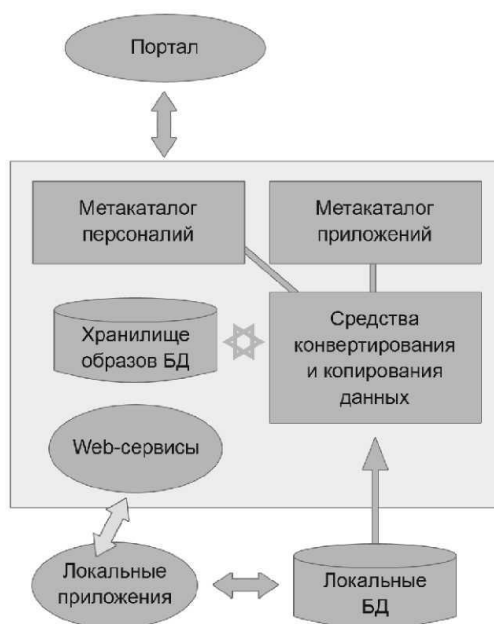
Рис. 2. Структура информационно-управляющего центра
