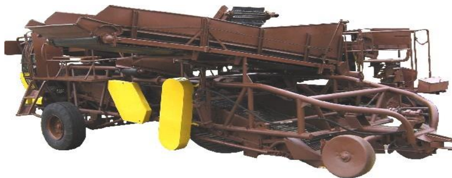
Рис. 3. Картофелеуборочный комбайн ККУ-2А
