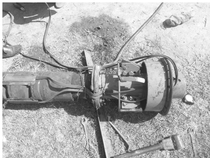
Рисунок 2. Устройство для беструбного водоподъема с присоединенным погружным электронасосом
