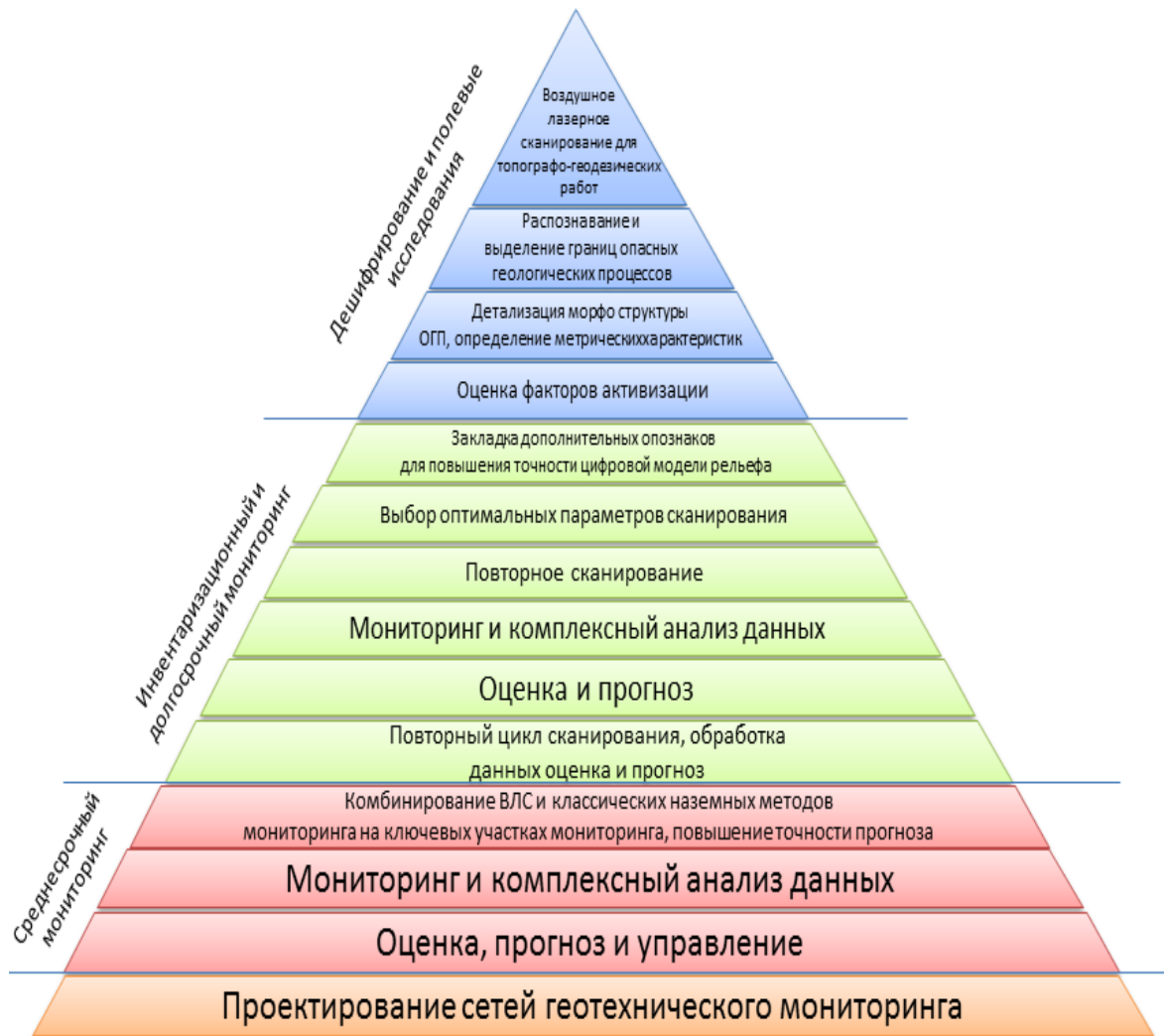
Рис. 1. Принципиальная схема мониторинга на основе воздушного лазерного сканирования, совмещённого с аэрофотосъёмкой. Верхняя точка пирамиды является началом познания изучаемого объекта. С постепенным увеличением своих познаний об объекте происходит увеличение основания пирамиды.
