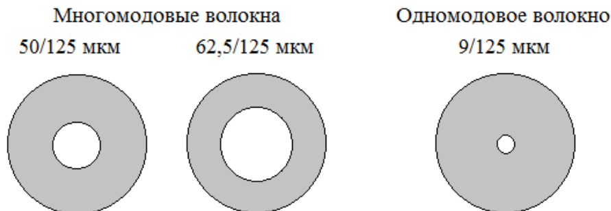
Рис. 8. Структура многомодовых и одномодовых световодов
