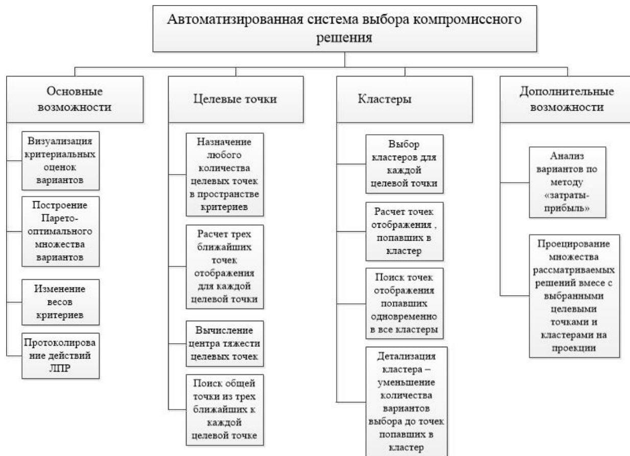
Рис. 3. Структурная схема автоматизированной системы выбора компромиссного решения по СИБ
