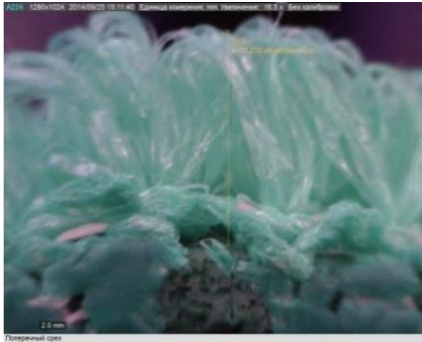
Рисунок 2. Микрофотография поперечного среза петельной загрузки
