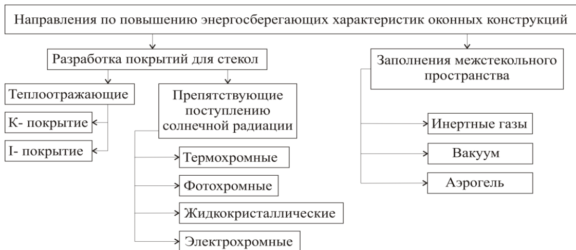
Рис. 1. Основные направления по повышению энергосберегающих характеристик окон
