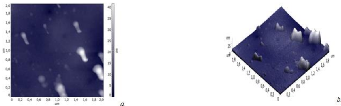
Рис. 2. Двухмерное (а) и трехмерное (б) изображения поверхности пленки (с площадью 2мкм x 2мкм) твердого раствора (Si_2)_{1-x}(CdS)_x ( 0 \leq x \leq 0.01 )
