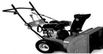
Рис. 1. Опытный образец передвижного механизированного ледоруба (снегоочиститель) ПМЛ-2010
