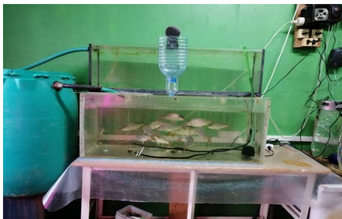
Рисунок 1. Установка замкнутого водоснабжения
