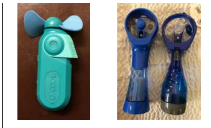
Фиг. 22, 23. Вентиляторы, и один синий – с наклеенными на лопасти магнитами
