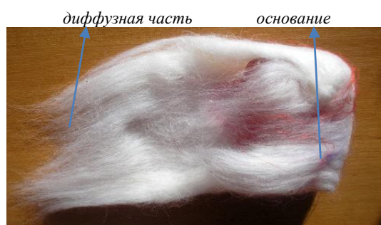
в) строение отрываемой пряжи
