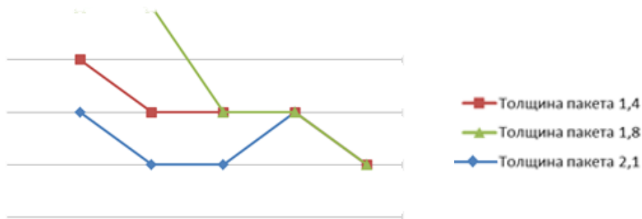
Рисунок 3. Зависимость величины уработки материалов внутреннего слоя пакета в горизонтальном направлении от толщины пакета и ширины переборки
