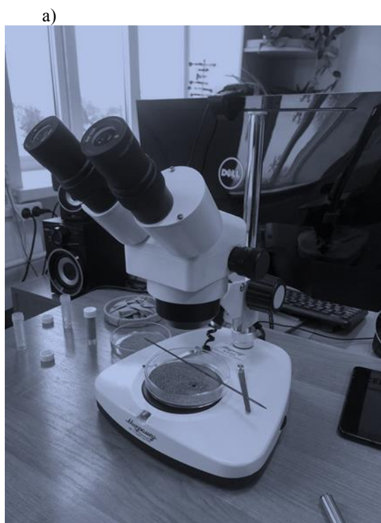
Рис. 16. Оборудование для исследования микропластика в отобранных пробах. а) Бинокулярный микроскоп Микромед МС-2, б) видео микроскоп CN-2210USB
