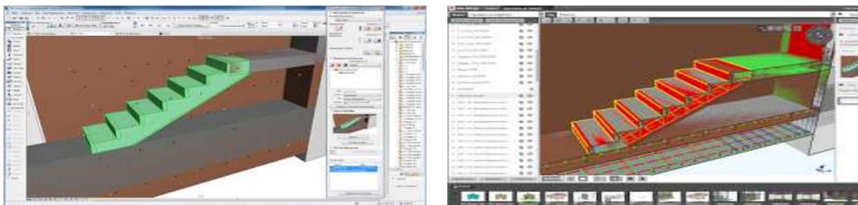
Рисунок 5. Несовпадение в размещении лестничного марша в разрезах АР и КЖ. Отображение спорного места в модели
