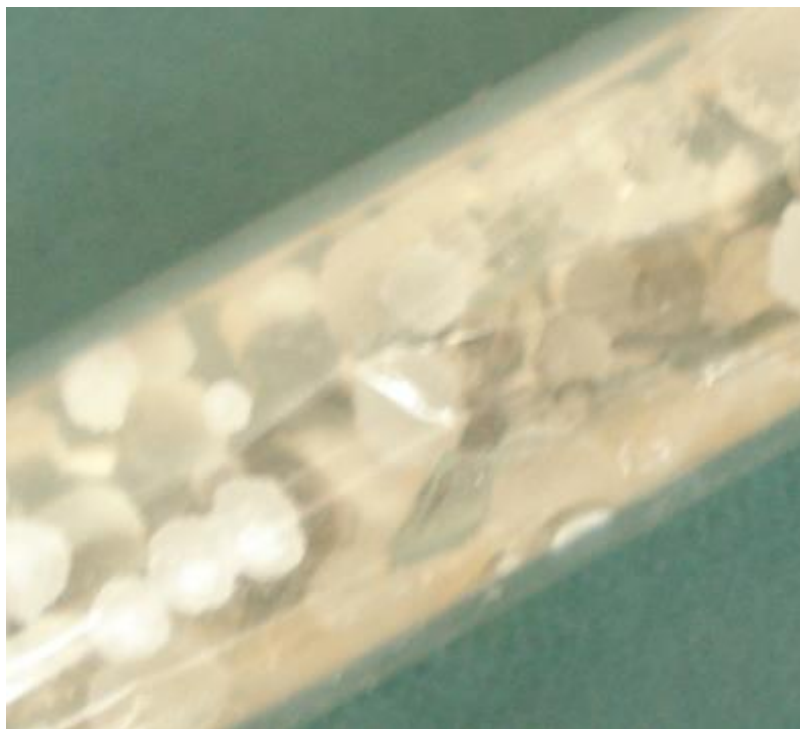
Фото 5. Сферолиты (дендримеры) \beta -хлорэтилметакрилата, образовавшиеся при спонтанной полимеризации при комнатной температуре
