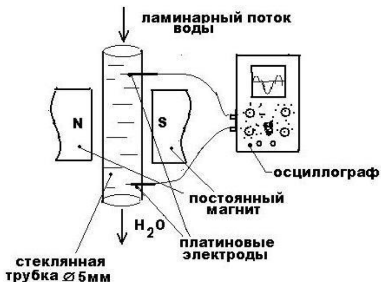
Рис. 9. Схема установки для изучения действия магнитного поля на воду
