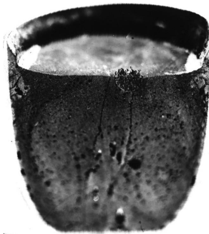
Рис. 8. Ретроградный распад королька сульфида сложного состава на поверхности шлака (видны волосовидные образования меди различной формы и диаметра).
