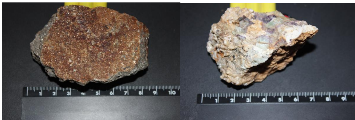
Рис. 12. Формы кристаллизации на поверхности больших кусков полиметаллической руды
