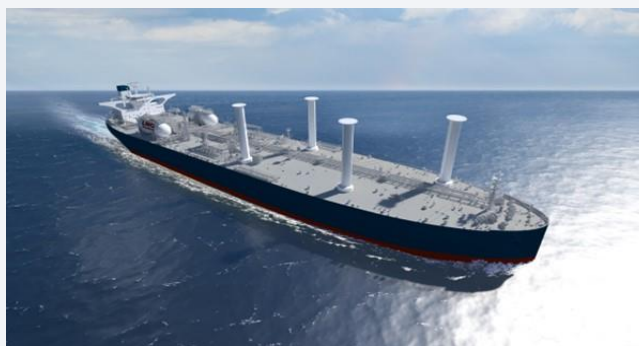
Рис. 2. Судно с вращающимися цилиндрами
