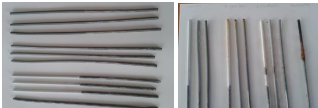
Рисунок 3. Стальные стержни до и после испытания: а – стержни до испытания; б – стержни после испытания
