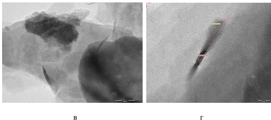
Рисунок 1. Микрофотографии углеродистого вещества шунгитов месторождения Бакырчик, просвечивающий электронный микроскоп JEM: а – фуллереноподобные частицы трубкообразной формы, б – распределение полярных высокодисперсных (0,1-10 мкм) кристаллических силикатных частиц в неполярной углеродной матрице, в – крупные глобулы шунгитового вещества, г – обособления трубкообразной формы
