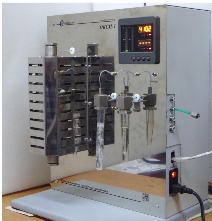
Рис. 1. Вид установки с лицевой стороны. Слева под защитным кожухом находится проточный реактор. Виден регулятор температуры, ниже его расположены две водяные ловушки, которые стоят на выходе газовых потоков
