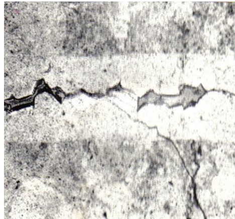
Рис. 5. Силецыт. Трещина поздней генерации проникает в прожилок кварца и соединяет нефтенасыщенные поры в нем. Скважина 1-Шевченко. Верхньоспасская подсвета интервал 6950-6954м. Ник II. X100
