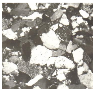
Рис. 2. Песчаник кварцевый мелкозернистый с кварцевым цементом порового типа. Комфорные структуры на контактах зерен кварца. Скважина 1 -Шевченко. Интервал 1951,5-1953,9м. Ник II. х70
