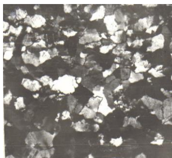
Рис. 1. Песчаник кварцевый среднезернистый. Комфорно-инкорпорационные структуры на контактах зерен кварца. Скважина 1 -Шевченко. Интервал 5074-5077м. Ник +. х70
