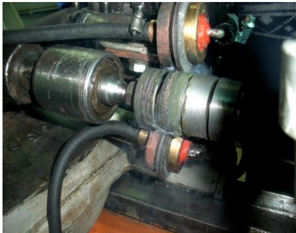
Рис. 3. Процесс имплантирования карбида вольфрама
