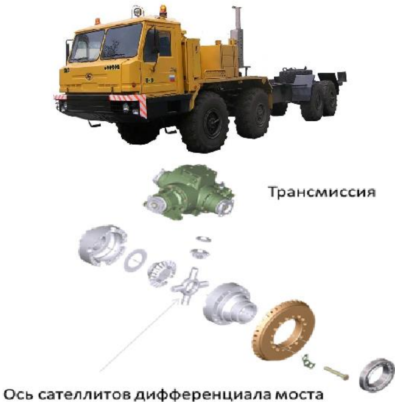
Рис. 8. Применение технологии ИКЭМО для повышения износостойкости узла трения «сателлит – ось сателлита»
