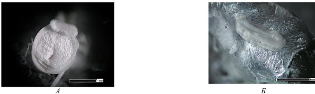
Рис. 2. Структура кварцосодержащей смеси в начале процесса затвердевания
