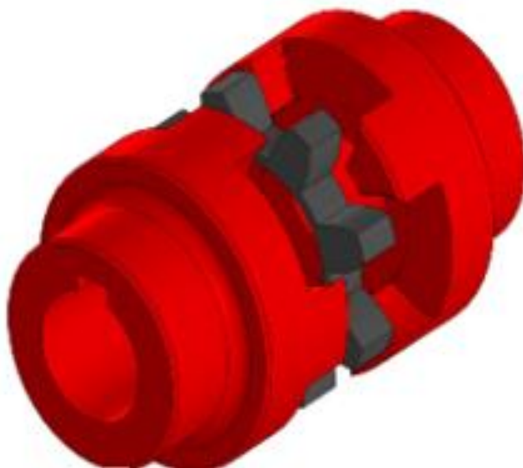
Рисунок 4. 3D модель кулачково-дисковой муфты в разборе
